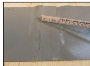
Junta de banda recta completamente soldada
