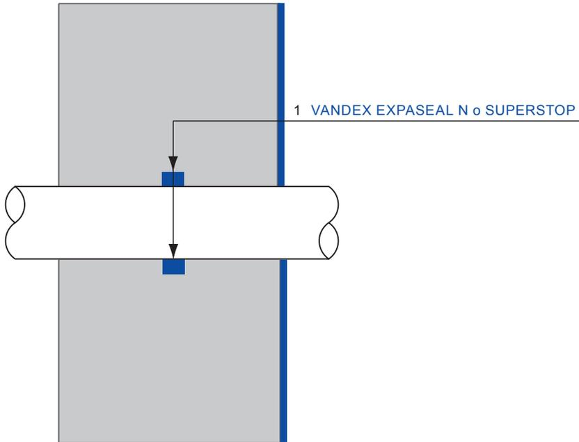
Tubo instalado en un hueco en el muro hormigonado anteriormente
